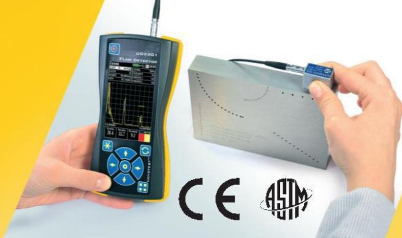
与标准型UD2301相比，QUAM UD2301-mini超声波探伤仪具有微小的机型，能在狭小并有限的空间中进行检测，其尺寸是最佳的。同时配备清晰的彩色显示器，高分辨率480×320像素，大大提高了设备的可用性。
